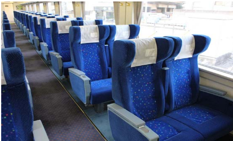
東武鉄道特急スペーシアのリニューアル車 一般席：シート表皮材、ウィルトンカーペット、カーテン コンパートメントルーム：シート表皮材、絨毯、カーテン
