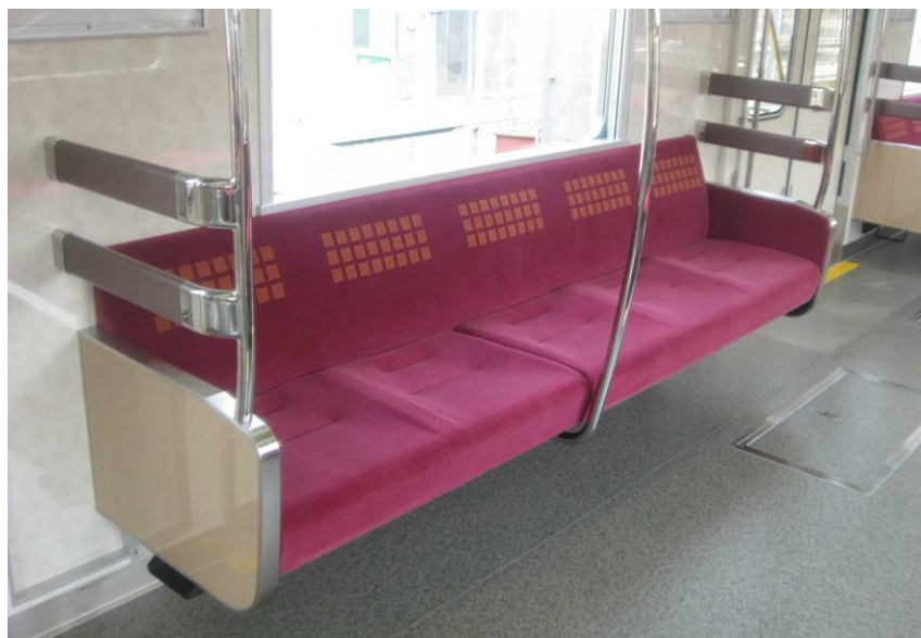
大阪市交通局 地下鉄御堂筋線30000系新型車両 シート表皮材:ウールドビーモケット シートクッション材(背・座):スミキューブ®
